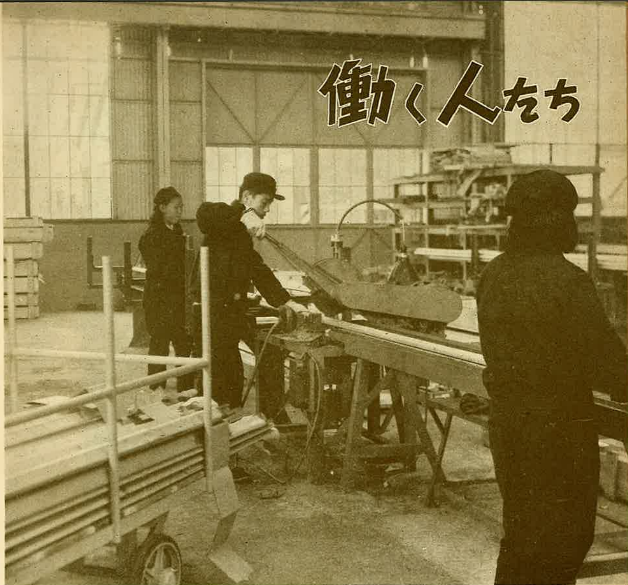
→ サツシの寸法に合わせて、押出型材を切断する。一ミリ狂つても仕上りまで影響してしまう。
