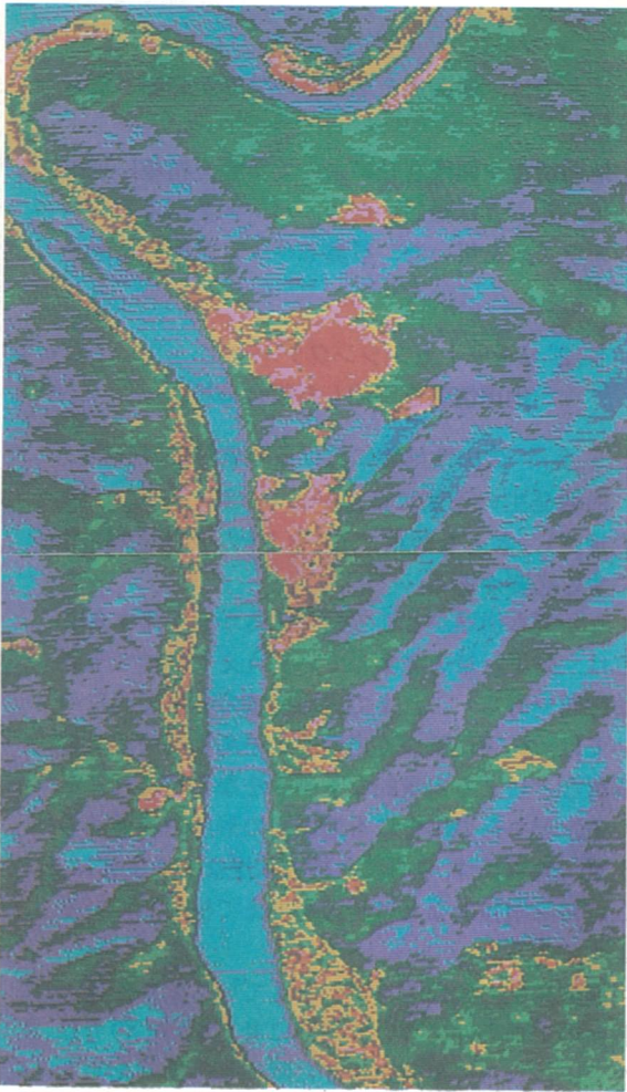
写真1 熱映像を用いたレベルスライス処理による未固結堆積物の抽出結果 (黄～赤色で示す範囲が未固結堆積物の分布域)
